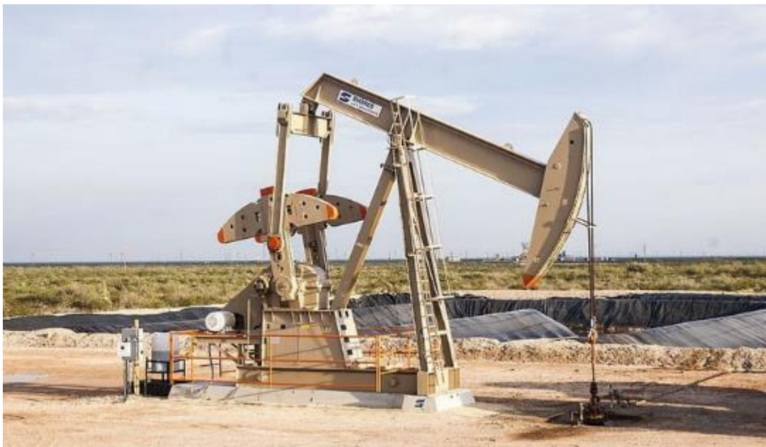
Рисунок 3 – Процесс добычи нефти при помощи установки штангового глубинного насоса (УШГН)
